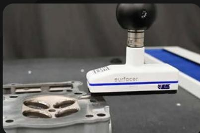
LK Metrology 推出全新 Surfacer SRP 表面粗糙度探頭，能在任何配備標準探頭的三坐標測量機 (CMM) 上即插即用，具備一微米解析度。此探頭可直接於 CNC 測量循環中分析零件表面粗糙度，無需手持儀器或二次檢測，實現一次夾具完成多工序測量，節省大量時間與成本。
