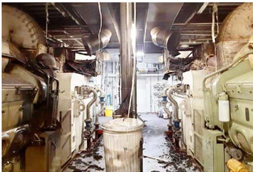
足夠扭力，引發零件斷裂以及過熱等等連鎖反應，導致引擎著火。該渡輪在事故發生前才剛完成一系列維修，正在進行航行測試時就發生事故，當下無人受傷。渡輪上13名船員僅在兩至三分鐘內就完成滅火，但這場火災仍造成價值380萬美元的損害，使韋納奇號停航9個月。
