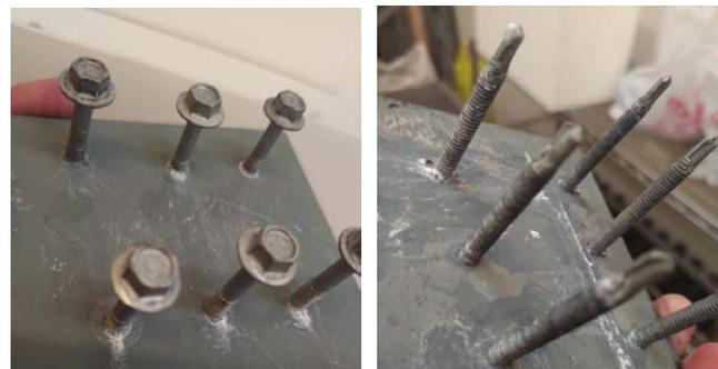
圖12. 碳鋼螺絲，經液態合金珠擊、富鋅鋁合金膜層塗佈，超過SST1000小時，不出紅鏽。
