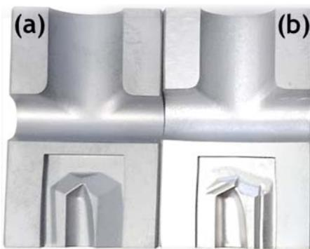
圖6. (a)經氧化鋁陶瓷粉末珠擊之鎢鋼夾尾模。(b)經液態合金粉末珠擊之鎢鋼夾尾模。試件(b)除了模面的粗糙度下降、放電加工殘留層與毛邊已完全清除。由模面顏色亦可以發現經液態合金粉末珠擊後表面明顯有合金鍍膜存在。
