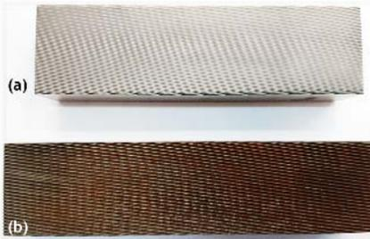
圖5. (a)經液態合金粉末珠擊強化後之高速鋼牙板模具，除搓牙壽命提升約30%~100%之外，因表面為壓縮殘留應力並沾鍍一層液態合金膜，放置30天後仍然無鏽蝕產生。(b)同一組高速鋼牙板經氧化鋁陶瓷粉末珠擊強化，放置30天後表面已嚴重鏽蝕。
