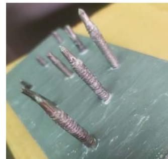
圖11. 304複合螺絲(Bi-metal screws)攻入鐵板，經24小時鹽測外觀。
