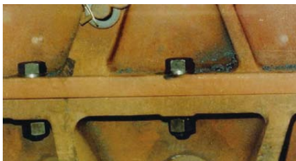
圖8.16 將CD紋螺栓鎖固到側壁
