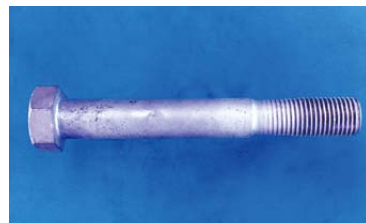
圖8.5 九州電力公司的電力供應鋼塔用的CD紋螺栓
