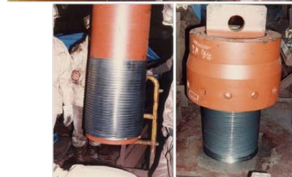
圖8.1 軋鋼廠的拉桿拉桿(長度 \phi 475 \times 13,975\text{mm} )
