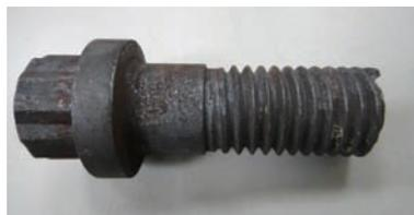
照片三：螺絲斷裂於螺帽鎖緊後第一牙螺紋處，表面有氧化層生成
