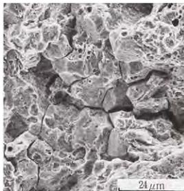
圖3.21 掃描式電子顯微鏡下延遲斷裂的觀測結果 (6)
