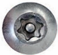
圖 11 顯示的是 Torx® 防拆。設計上結合了中央的一個柱體避免用戶使用標準起子頭來接合。不幸
