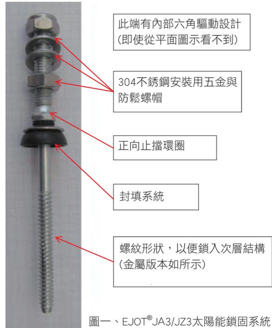
圖一、EJOT®JA3/JZ3太陽能鎖固系統
