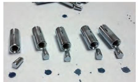
圖1：擴張插銷以及塑膠片(塞子)脫落
