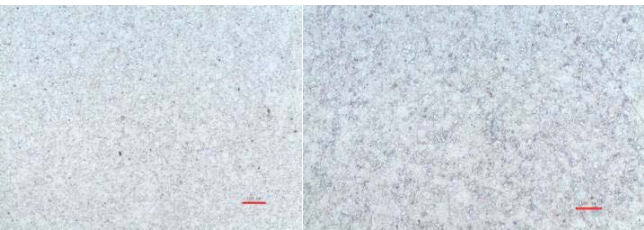
100X 200X GH4169合金 图3 固溶+时效处理，王水腐蚀
