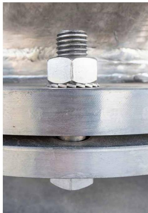
圖 6: 外齒型鎖緊墊圈的應用
