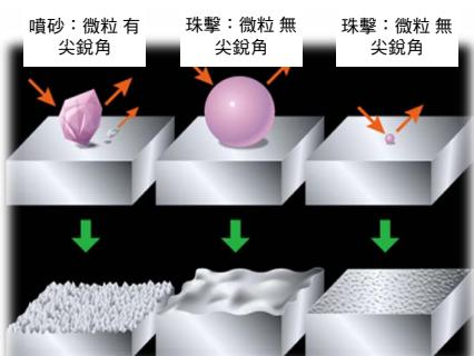
圖2. 噴砂與珠擊製程示意圖<sup>[2]</sup>。
