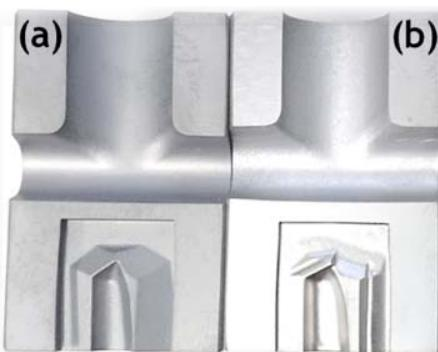
圖6. (a)經氧化鋯陶瓷粉末珠擊之鎢鋼夾尾模。(b)經液態合金粉末珠擊之鎢鋼夾尾模。試件(b)除了模面的粗糙度下降、放電加工殘留層與毛邊已完全清除。由模面顏色亦可以發現經液態合金粉末珠擊後表面明顯有合金鍍膜存在。
