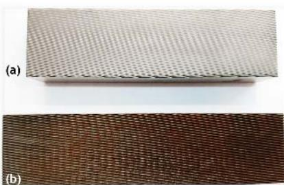
圖5. (a)經液態合金粉末珠擊強化後之高速鋼牙板模具，除搓牙壽命提升約30%~100%之外，因表面為壓縮殘留應力並沾鍍一層液態合金膜，放置30天後仍然無鏽蝕產生。(b)同一組高速鋼牙板經氧化鋯陶瓷粉末珠擊強化，放置30天後表面已嚴重鏽蝕。
