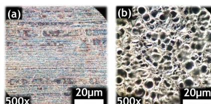
圖7. (a)金屬表面珠擊前光學顯微鏡暗視場(Dark field)圖。(b)金屬表面珠擊後之形貌，黑色為凹入，深度約0~3微米。
