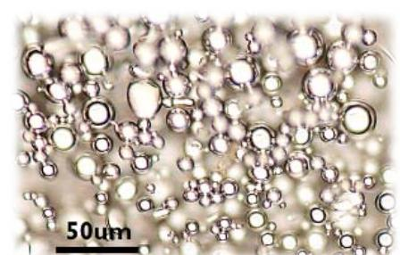
圖4. 液態合金粉末。具有極高的硬度與極強的耐腐蝕能力。
