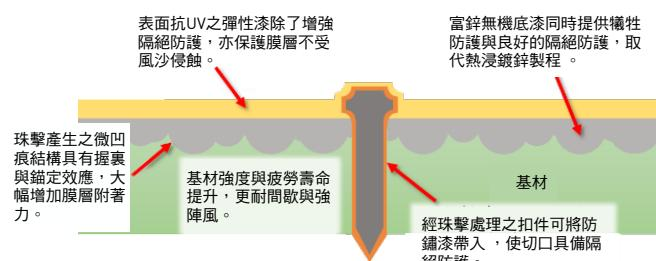
圖13. 針對台灣特殊環境需求所設計之扣件與結構材料耐鏽蝕處理程序示意圖。
