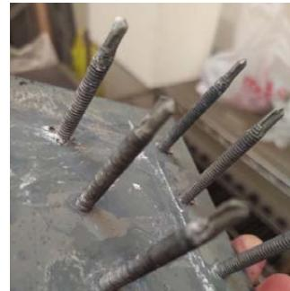
圖12. 碳鋼螺絲，經液態合金珠擊、富鋅鋁合金膜層塗佈，超過SST1000小時，不出紅銹。
