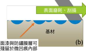
圖8. 膜層於珠擊表面受到外力磨除時，可部份殘存於微凹洞內的示意圖。
