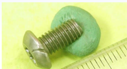
圖7. 螺絲頭部冷鍛(打)硬裂外觀
