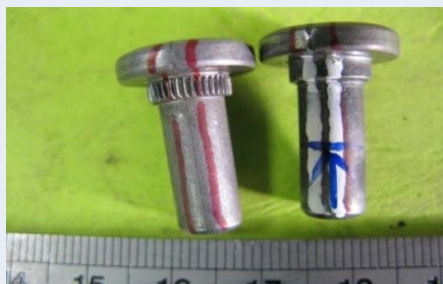
圖4. 螺絲表面冷打裂外觀
