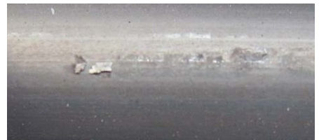
圖1. 鋼材表面剝片缺陷外觀
