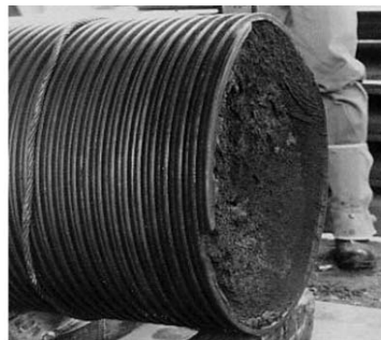
圖10.2 拉桿螺帽的斷裂表面外觀
