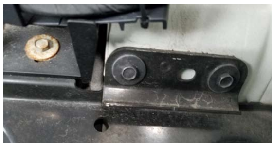
圖2. 引擎蓋下方托架上的8.8級扣件
