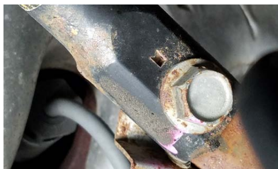
圖3. 轉向桿連接處上的10.9級扣件
