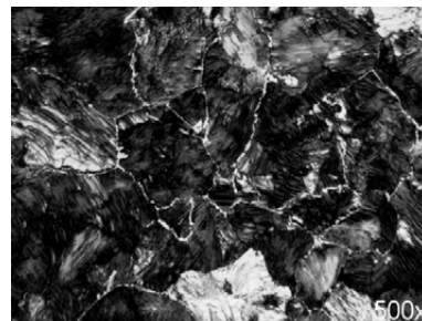
圖3 SUJ2軸承鋼熱軋組織
