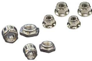
1. 特殊預置扭矩六角突緣螺帽連結器為尼龍防鬆法蘭金屬螺帽，使用於汽車懸吊系統緊固作業上，產品符合Daimler組裝廠規範之扣件標準MBN 13025、與電鍍處理DBL 9440.47，具防鬆脫、耐用、抗腐蝕等特性。此一系產品被指定使用於賓士A,B,C,E,S等各級全球性車款，每年共計有2000萬輛以上賓士新車款使用環鋒工業之產品，其使用年限可達20年以上。
