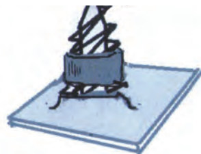
標準的凸出是標準自攻螺絲切削出來的，留下不到1/2節徑的啮合
