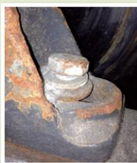
因為勉強要尺寸過小的緊扣件裝配上去，他們設法先用一個 USS 平墊圈，然後再用一個 SAE 平墊圈去填補 USS 墊圈過大的內徑。
