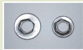
墊圈因此產生壓痕的這個事實也同樣是個重大的問題，因為這兩種墊圈都只是由普通鍛鐵製造。這些壓痕是緊固件以正常方式扣緊時造成的。使用中的承重也更進一步的嵌入。這些凹痕表示：螺栓失去如此多等量的預置荷重。根據胡克定律 (Hooke's law)，螺栓每鬆弛 0.001" 的承重長度，接合就失去 30,000 psi 的夾緊力。這可能表示相當於一個螺栓強度等級的損失。
