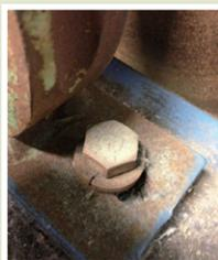
右圖顯示的是別的裝配組，他們只用單一個硬化的 USS 平墊圈。USS 平墊圈以其較大的空孔和較大的內徑，形成在邊緣部位的應力造成硬化墊圈龜裂。這會導致夾緊力喪失，並且造成承重支撐的移動。這種支撐一旦出現移動，會造成心軸不正，導致承重部位的磨損和故障。
