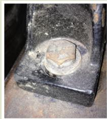
相對於裝配孔的尺寸，使用在接合處的螺栓及平扁式 SAE 墊圈都太小。墊圈和螺栓組配件緊扣在裝配孔內，但振動和常態運動使得裝配孔變得越來越大；甚至有一個枕塊組配件已出現龜裂。
