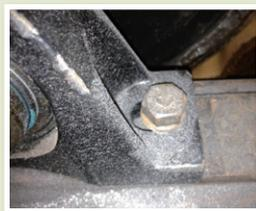
這位客戶使用幾種不同尺寸規格的枕塊。以緊固件實際測量，其中一枕塊適合 5/8" 規格的螺栓，其他則適合 3/4" 螺栓。然而，在裝配的現場，我們發現如下所示的實例：
