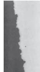
圖1. 8 \phi mm 6150鋼種網狀斑紋外觀 圖2. 金相觀察缺陷深0.03mm
